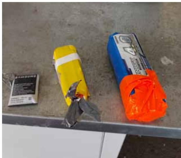
*Richtig abgeklebte Lithiumbatterien*
